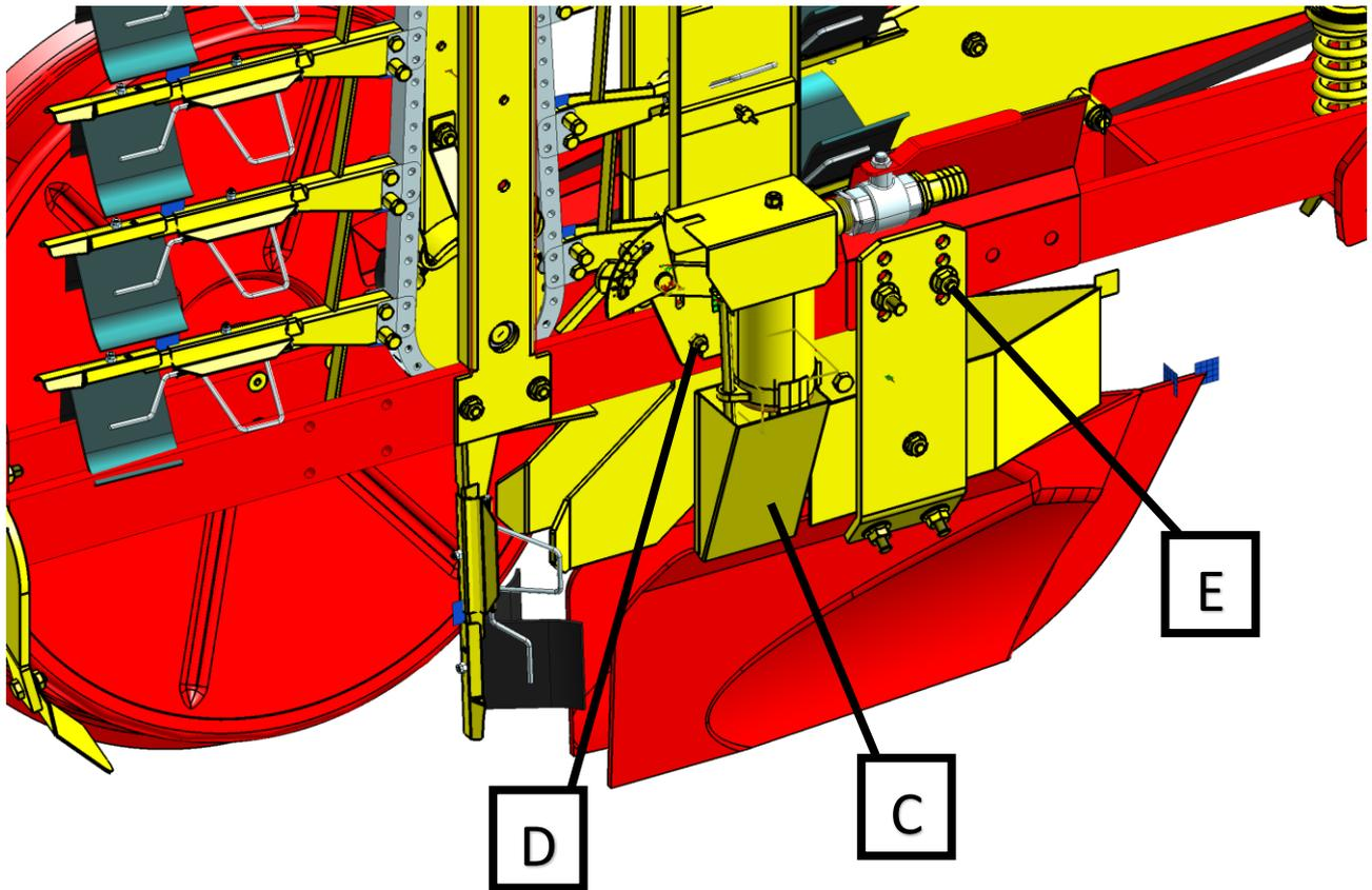
Posizionare il dispositivo di innaffiamento sull'unità e fissarlo con le viti D in posizione.
